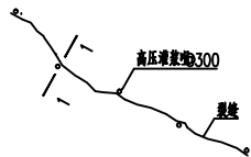
结构裂缝高压灌浆修复平面示意图
